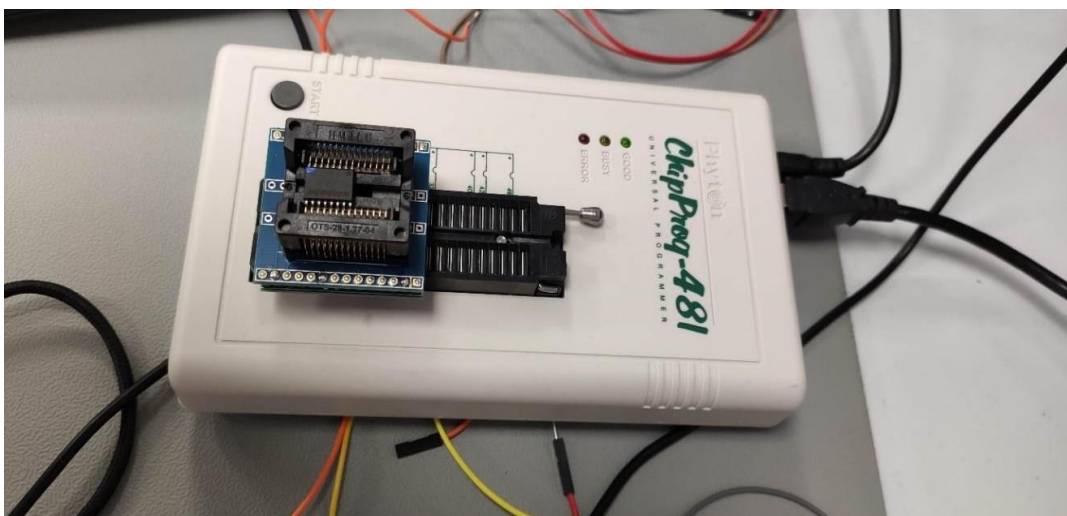
Рис. 2 Установка микросхемы Flash-ROM в адаптер программатора
