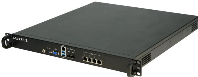
Стоечная система 1U для сетевых устройств на базе Atom C3558/C3758 с возможностью расширения.
